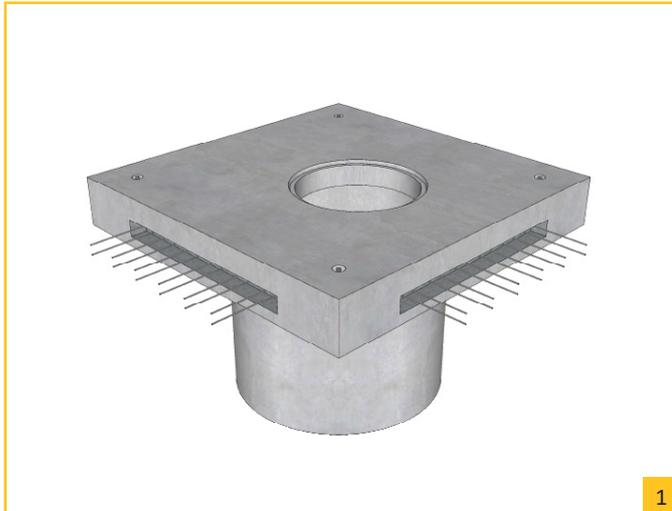
Le but d'un couvercle flottant est de répartir les charges de trafic par le couvercle sur la fondation ou le revêtement de la route. Cela permet un soulagement de charges pour les puits d'inspection sous-jacent et d'éviter les tassements nuisibles.
